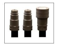
Um die Standardkupplungen zu verbinden oder zu trennen, bewegen Sie den Kragen zum Ende des Anschlussstücks mit Innengewinde. Die Schläuche müssen so angeschlossen werden, dass das mit einer farbigen Kappe versehene Anschlussstück mit dem entsprechenden Anschlussstück des Laders verbunden ist. Beachten Sie, dass die Schutzkappen von Lader und Anbaugerät während des Betriebs aneinander befestigt werden können, um die Schmutzansammlung zu verringern.
